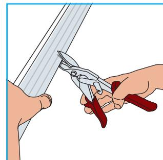
КНАУФ-профили толщиной более 0,7 мм нельзя разрезать ручными ножницами. Необходимо использовать электрический инструмент. Выбор инструмента зависит от системы покрытия. Это особенно важно для лаков и других органических покрытий, которые могут быть повреждены под воздействием высокой температуры или искр. Рекомендуется использовать ленточную пилу.
