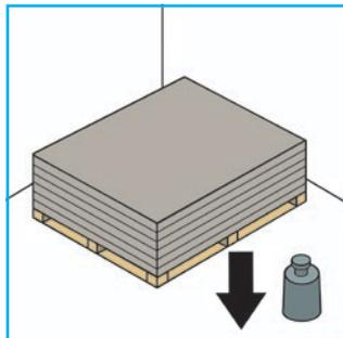
Для защиты от увлажнения плиты рекомендуется хранить под навесом. Перед монтажом намоченные плиты следует высушить с обеих сторон.
