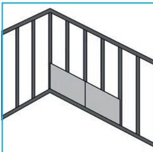
5.3 Клей для швов наносится непрерывной полоской по всей кромке плит. Необходимо следить, чтобы края плит были очищены от пыли с помощью влажной кисти. Расход клея составляет ок. 50 мл/м<sup>2</sup> (40 мл/м). Количество клея рассчитано максимум на 6,5 м<sup>2</sup>.
