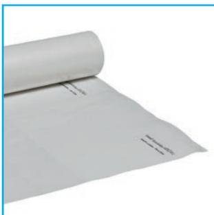
Паронепроницаемый барьер Кнауф Зашцата В изготовлен из специальной полипропиленовой пленки, устойчивой к старению. Паропроницаемость (мГ/м<sup>2</sup>\*ч\*Па) – 0,0000076
