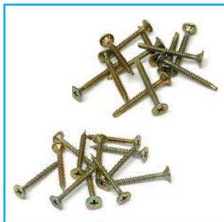
АКВАПАНЕЛЬ® Шурупы специально разработаны для крепления обшивки различной толщины цементных плит АКВАПАНЕЛЬ® Внутренняя к каркасу. Применяются винты с острым или высверливающим концом с утапливаемой головкой. АКВАПАНЕЛЬ® Шурупы применяются для крепления
