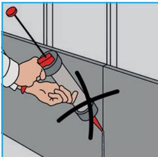
5.2 Монтируемая плита плотно прижимается к уже закрепленной через нанесенную полоску клея, после чего крепится к каркасу при помощи шурупов. Клеевое соединение плит исключает необходимость последующего шпаклевания стыка с применением армирующей ленты.
