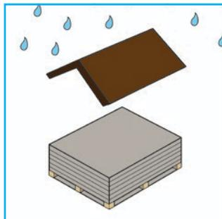
При хранении цементных плит АКВАПАНЕЛЬ® в условиях отрицательных температур, перед использованием их следует переместить на поддоне в отапливаемое помещение. Перед монтажом плиты должны акклиматизироваться. Температура материала и окружающей среды не должна быть ниже +5°C.
