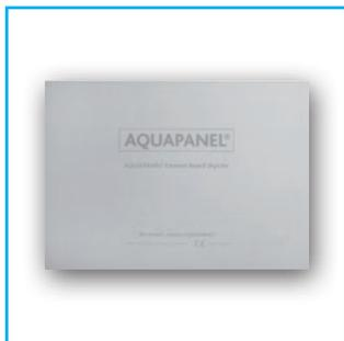
Плита состоит из сердечника на основе портландцемента и легкого минерального заполнителя. Все плоскости плиты, кроме торцевых кромок, армированы стеклосеткой. Торцевые кромки (Easy Edge™) для усиления дополнительно армированы стекловолокном.
