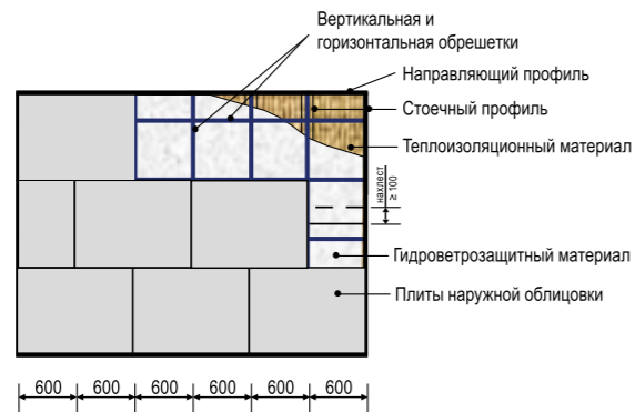
Рис. 21. Крепление наружной облицовки к каркасу
